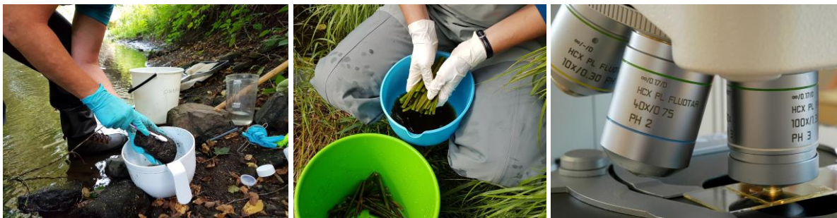
Figur 23. Provtagning av kiselalger görs i första hand från sten. Metoden innebär att minst 5 slumpvis valda stenar plockas upp ur vattnet och borstas av från ovansidan med en ren tandborste. Materialet sköljs av och samlas upp i ett kärl. av kiselalger görs i första hand från sten genom att påväxten borstas av. Om inte stenar finns eller om det t.ex. är för djupt, kan prov även tas från vattenväxter genom att växtdelar som befunnit sig väl under vattnet skakas, eller "tvättas" av. På laboratoriet prepareras kiselalgsskalen fram och fixeras på objektglas. Kiselalgsanalys görs i ljusmikroskop i 1000 gångers förstoring med oljeimmersionsobjektiv. Mikroskopet ska helst vara utrustat med interferenskontrast, vilket gör att man kan se mycket små former tydligare än med andra tekniker. © Medins Havs och Vattenkonsulter AB
